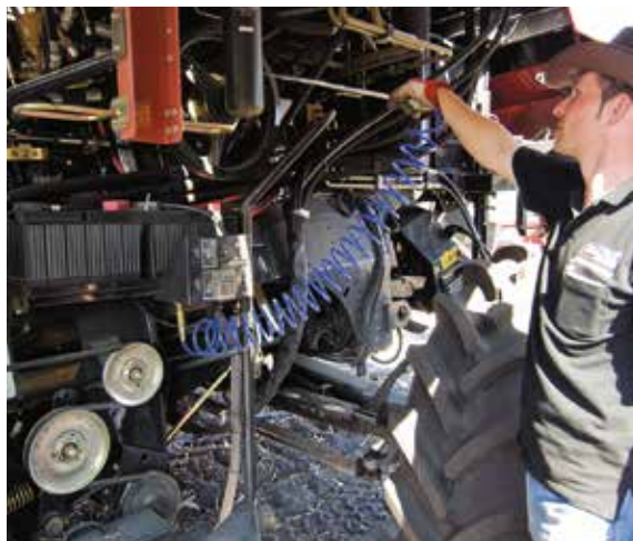
Codzienne kontrole i czyszczenie zostały ułatwione dzięki nowemu odchylanemu zespołowi chłodnic, natomiast filtr powietrza znajduje się w miejscu ułatwiającym szybką kontrolę
