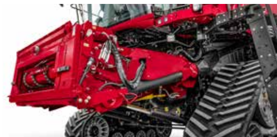
Pochylenie zespołu żniwnego do przodu / do tyłu w celu ustawienia kąta natarcia pozwala podbierać wyległe uprawy i ograniczać straty.
