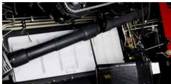
Napęd Power Plus pozwala przenosić dużą moc do pochylonego przenośnika wlotowego i zespołu żniwnego. Prosta konstrukcja o prostej konserwacji
