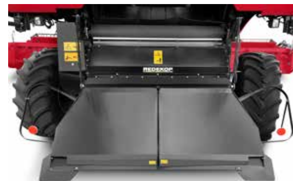
System rozdrabniania X-tra Chopping z niezależnymi płytami rozrzutnika
