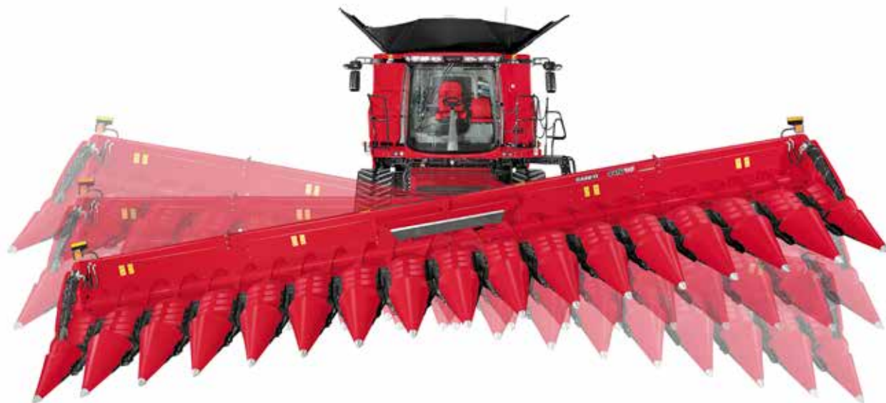
Stosowany przez Case IH system kopiowania terenu zapewnia utrzymywanie zadanej wysokości koszenia nawet na najbardziej nierównym terenie.
