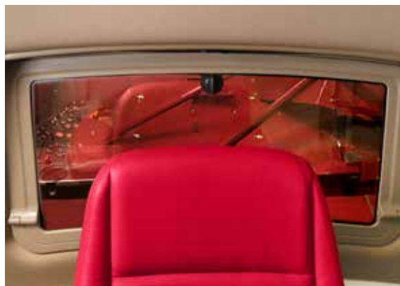
Duże okno inspekcyjne za fotelem operatora
