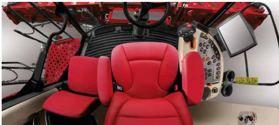
Kabina w wersji Luxury z wysokim fotelem z tapicerką skórzaną i podgrzewaniem
