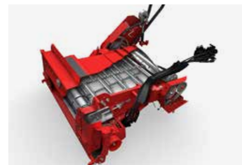
Możliwość współpracy z zespołami żniwnymi o szerokości nawet 9,15 m i zabezpieczenie kombajnu dzięki nowemu wałkowi spiralnemu i wyłapywaczowi kamieni.
