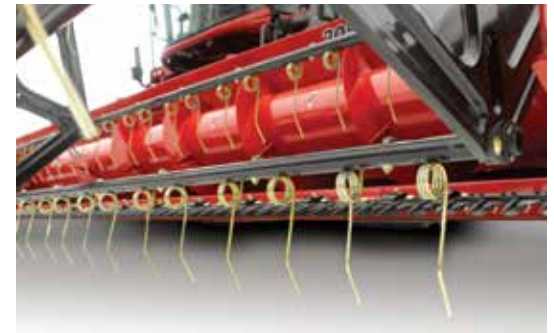
Pálce sięgają 7,5 cm poniżej listwy nożowej, podnosząc uprawę bez ryzyka uszkodzenia zespołu tnącego.
