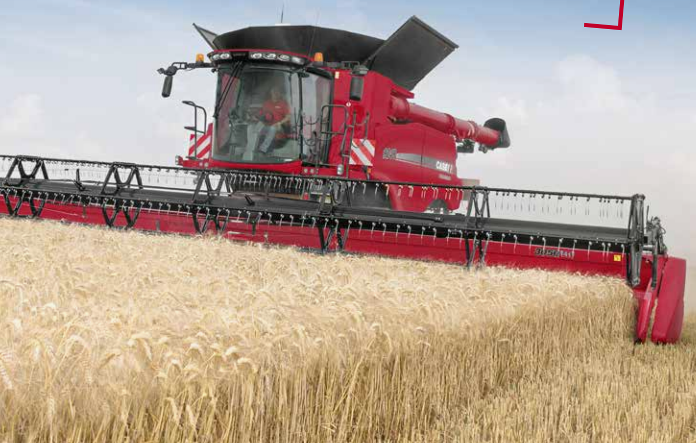
Pálce sięgają 7,5 cm poniżej listwy nożowej, podnosząc uprawę bez ryzyka uszkodzenia zespołu tnącego.
