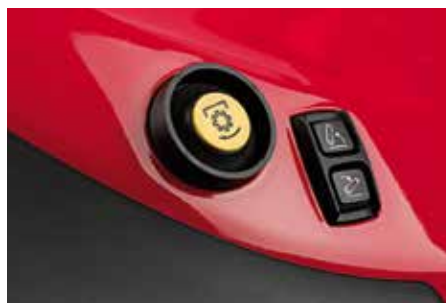
Zewnętrzne elementy sterowania umożliwiają szybkie i łatwe doczepienie narzędzia.
