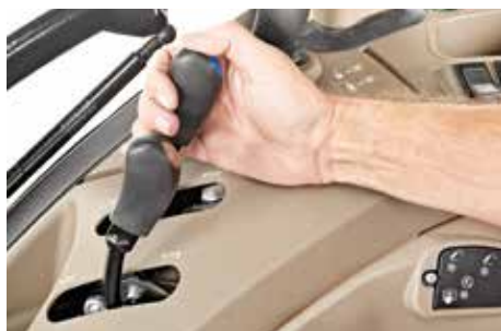
W ciągnikach Farmall C można zamontować maksymalnie trzy mechanicznie sterowane tylne zawory zewnętrznego układu hydraulicznego.
