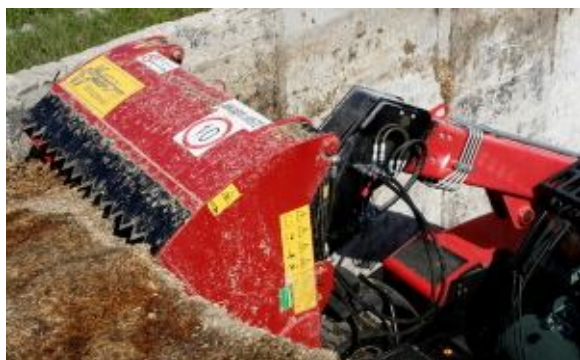
Wycinak kiszonki jest to urządzenie do zadawania pasz. Standardowy WK 1,45 pobiera 1m 3 kiszonki.
