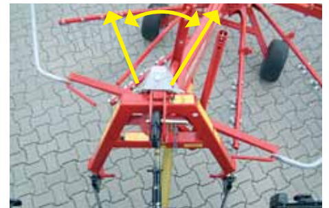
Z 3 punktowym kołem przegubowym zgrabiarka na wszystkich zakrętach pewnie podąża za ciągnikiem.
